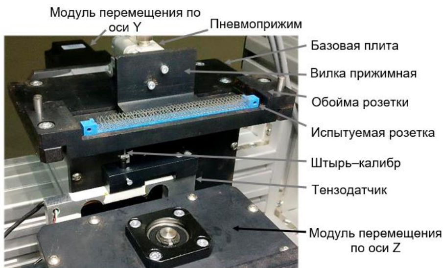
Рисунок 4.6 – Внешний вид расположения измерительных узлов установки
