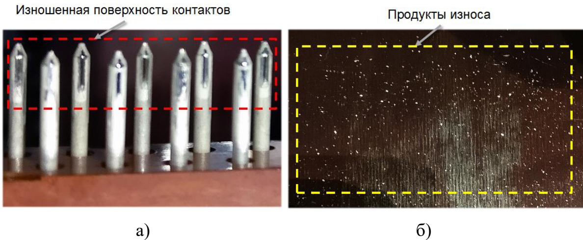
Рисунок 4.26 – Разрушение ЭС в процессе последовательного сочленения–расчленения: а) внешний вид изношенных контактов; б) продукты механического износа
